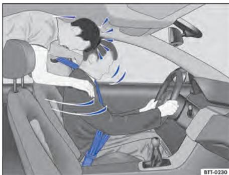
**Fig. 33** O passageiro sem cinto de segurança no banco traseiro é lançado para frente sobre o condutor com cinto de segurança.
