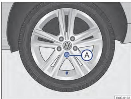
Fig. 172 Troca de roda: seqüência de remoção dos parafusos da roda.
