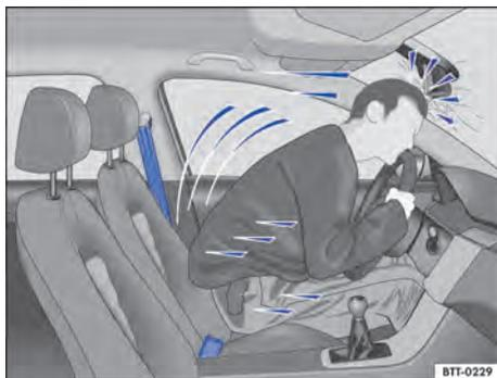
**Fig. 32** O condutor sem cinto de segurança é lançado para frente.
