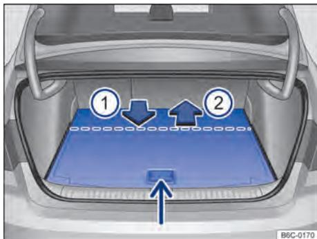
**Fig. 120** No compartimento de bagagem: ajustar a altura do assoalho variável do compartimento de bagagem.
