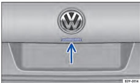
Fig. 65 Na tampa traseira: botão para abrir a tampa traseira.
