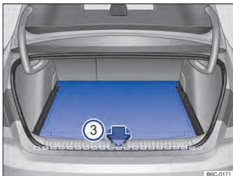
**Fig. 121** No compartimento de bagagem: assoalho variável do compartimento de bagagem .
