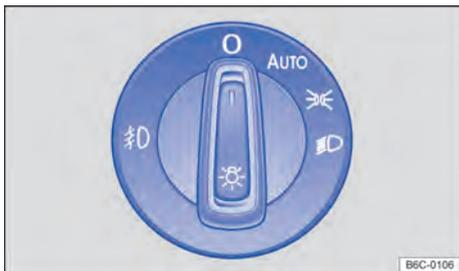
**Fig. 78** Ao lado do volante: interruptor de luzes (uma variante).
