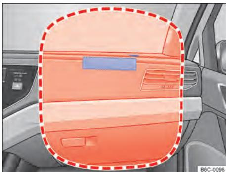
**Fig. 42** Local de instalação e área de expansão do airbag frontal do passageiro dianteiro.
