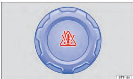
Fig. 157 No compartimento do motor: tampa do reservatório de expansão do líquido de arrefecimento do motor.
