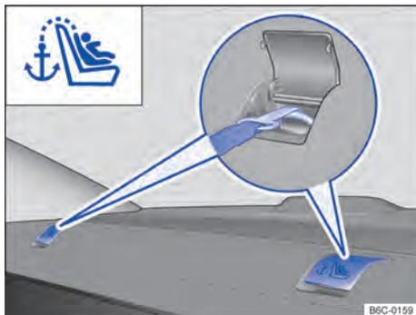
**Fig. 49** Olhais de retenção para o cinto de fixação superior na cobertura do compartimento de bagagem.
