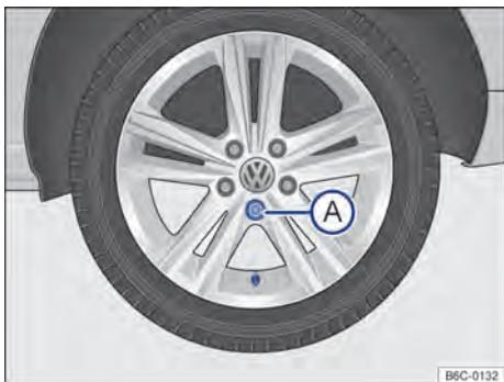
Fig. 167 Retirar a calota integral.
