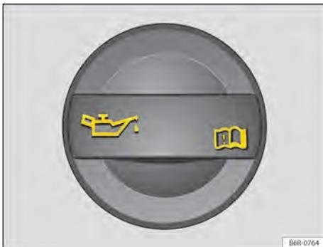
Fig. 155 No compartimento do motor: tampa da abertura para enchimento de óleo do motor.
