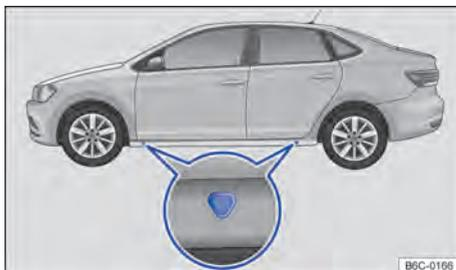
Fig. 170 Pontos de apoio do macaco.
