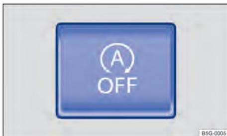
Fig. 97 Na parte inferior do console central: botão do sistema Start-Stop.
