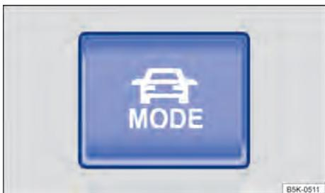
Fig. 103 No console central: botão MODE na seleção do perfil de condução.
