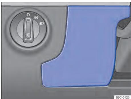
Fig. 142 No lado do condutor do painel de instrumentos: cobertura da caixa de fusíveis.
