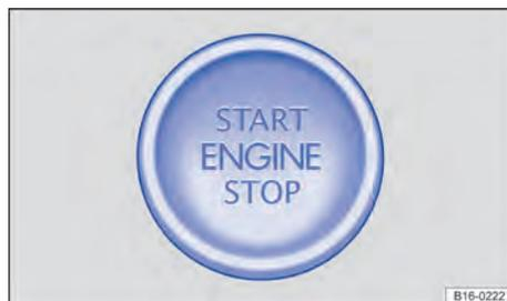
**Fig. 95** Na parte inferior do console central: botão de partida para ligar o motor.
