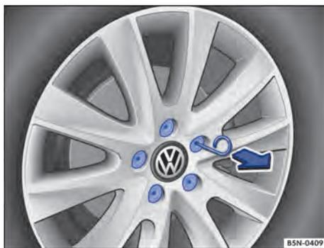
Fig. 168 Remover as capas de cobertura dos parafusos de roda.
