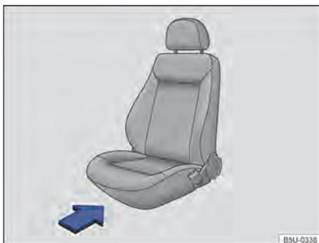
Fig. 54 Na parte frontal do banco do passageiro dianteiro: localização para instalação do suporte do extintor de incêndio.
