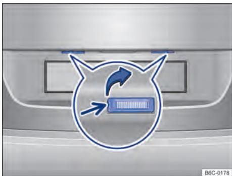
**Fig. 140** No para-choque traseiro: lanterna da placa de licença.
