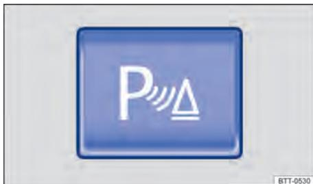
**Fig. 107** No console central: botão para ligar e desligar o auxílio de estacionamento (dependendo da versão do veículo).
