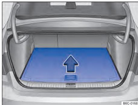
**Fig. 119** No compartimento de bagagem: levantar o assoalho variável do compartimento de bagagem.
