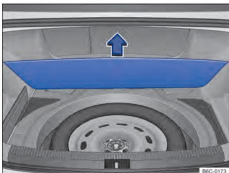
Fig. 126 No compartimento de bagagem, sob o revestimento de assoalho: roda de emergência e ferramentas de bordo.
