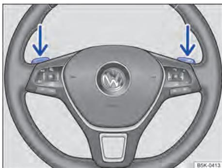
Fig. 101 Volante com seletores basculantes do Tiptronic.
