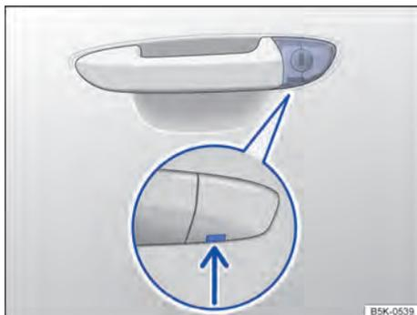
Fig. 60 Maçaneta da porta do condutor: cilindro da fechadura coberto.
