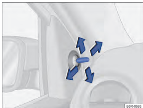
Fig. 78 Nas portas dianteiras: botão de ajuste dos espelhos retrovisores externos mecânicos.
