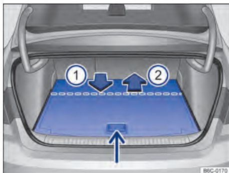
Fig. 127 No compartimento de bagagem: ajustar a altura do assoalho variável do compartimento de bagagem.
