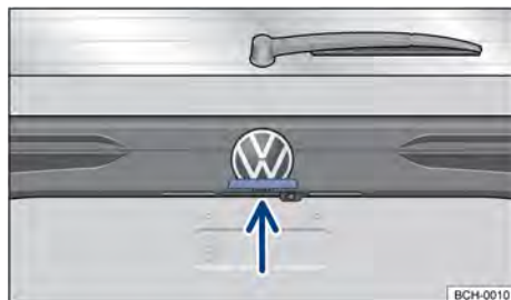
Fig. 60 Na tampa traseira: botão para abrir a tampa traseira.
