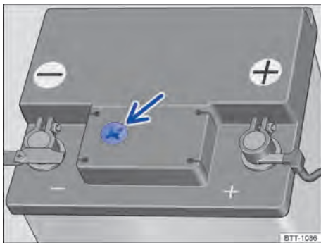
Fig. 159 No compartimento do motor: exemplo de posição do visor no lado superior da bateria do veículo.
