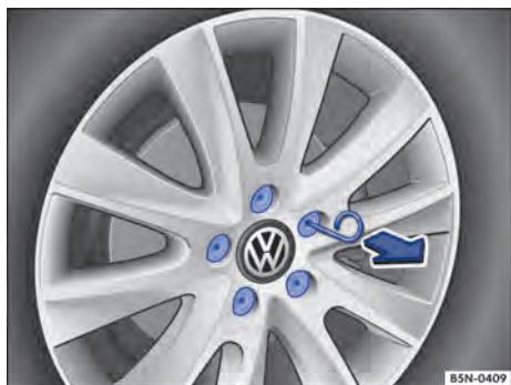
Fig. 167 Remover as capas de cobertura dos parafusos de roda.
