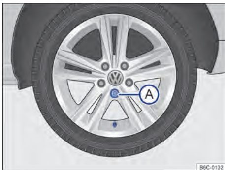
Fig. 170 Retirar a calota integral.
