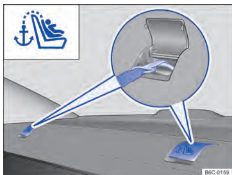
Fig. 43 Olhais de retenção para o cinto de fixação superior na cobertura do compartimento de bagagem.
