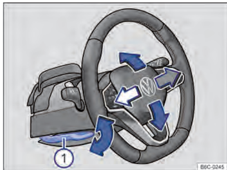
Fig. 63 Embaixo e a esquerda do volante junto com o revestimento da coluna de direção: alavanca de ajuste da posição do volante.
