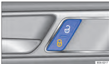
Fig. 53 Na porta do condutor: botão do travamento central.
