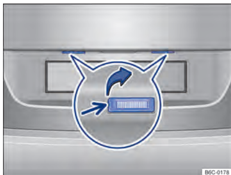
Fig. 139 Na tampa traseira: lanterna da placa de licença.
