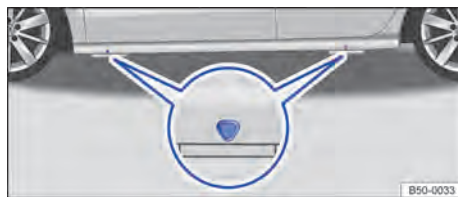
Fig. 168 Pontos de apoio do macaco.
