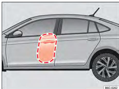
Fig. 37 No lado esquerdo do veículo: áreas de expansão do airbag lateral.
