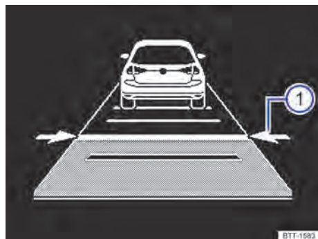
Fig. 103 No display do instrumento combinado: ajustar a distância (representação esquemática, o ACC regula).
