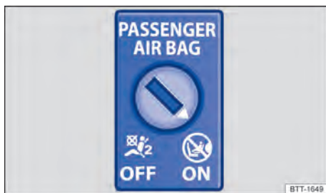
Fig. 36 No painel de instrumentos no lado do passageiro dianteiro: interruptor acionado pela chave para desligar e ligar o airbag frontal do passageiro dianteiro.
