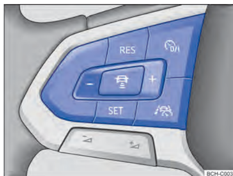
Fig. 102 Lado esquerdo do volante multifunções: botões para comandar o ACC. (variante 2)
