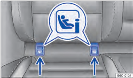
Fig. 42 No banco do veículo: identificação dos pontos de ancoragem inferiores para cadeiras de criança.
