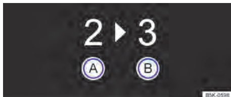
Fig. 85 No instrumento combinado: indicador de troca de marcha.
