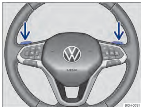
Fig. 93 Volante com seletores basculantes do Tiptronic.
