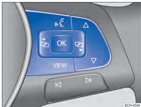
Fig. 17 Lado direito do volante multifunções (variante 1): botões para comando dos menus e exibições de informação do instrumento combinado.
