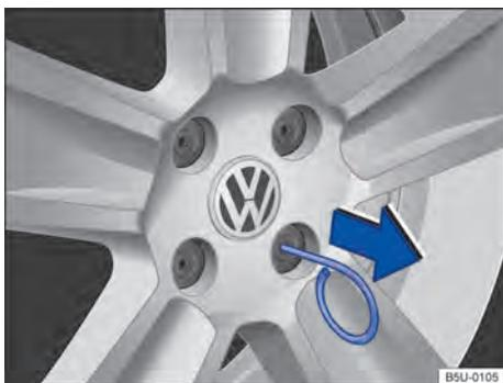
Fig. 186 Retirar as capas de cobertura dos parafusos da roda.
