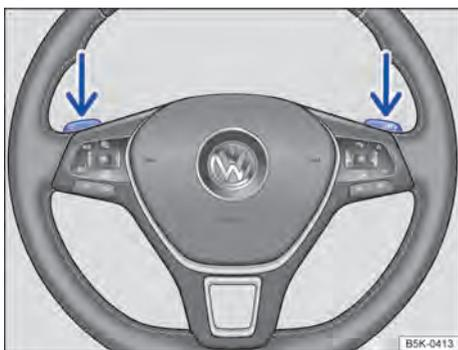
Fig. 85 Volante com seletores basculantes do Tiptronic.
