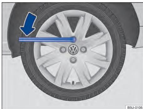
**Fig. 188** Troca de roda: soltar os parafusos da roda.
