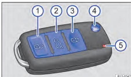
Fig. 43 Chave do veículo com comando remoto.
