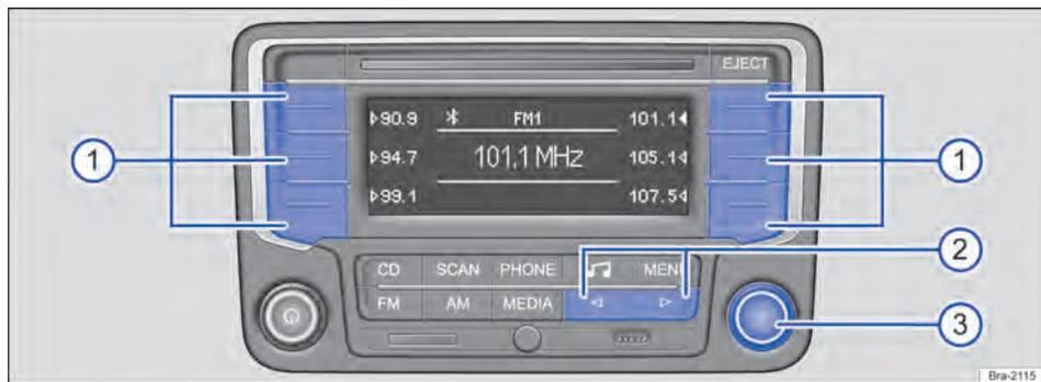
Fig. 130 Troca de estação por meio dos botões de função ou dos botões do aparelho.
