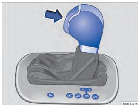
Fig. 83 Alavanca seletora da transmissão automática com botão bloqueador (seta).
