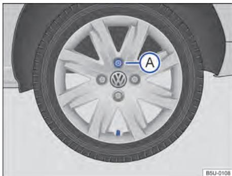
Fig. 190 Troca de roda: seqüência de remoção dos parafusos da roda.
