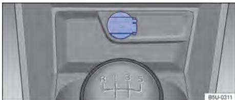
Fig. 97 No console central dianteiro: tomada 12 V.
