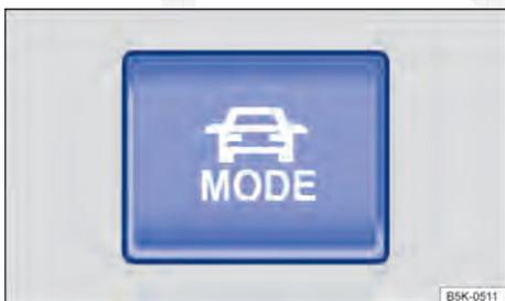
Fig. 165 Na parte inferior do console central: botão de seleção do perfil de condução.
