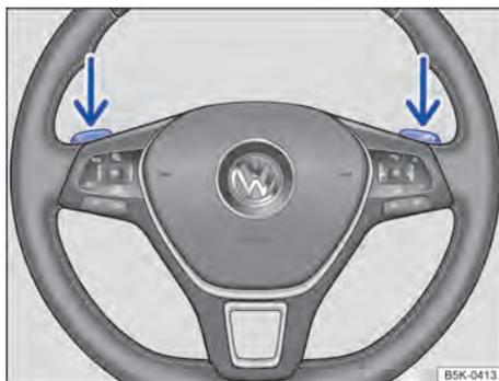
Fig. 126 Volante com 2 seletores basculantes do Tiptronic.
