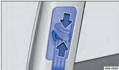
**Fig. 65** Ao lado dos bancos dianteiros: regulagem de altura do cinto de segurança.
