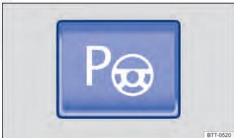
Fig. 142 Na parte inferior do console central: botão para ligar o assistente de direção para estacionamento.
