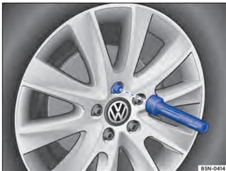
**Fig. 211** Troca de roda: desparafusar os parafusos de roda com o punho da chave de fenda.
