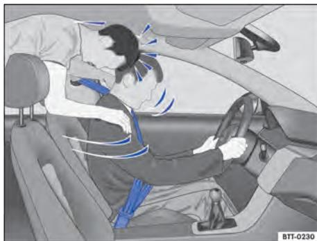
**Fig. 59** O passageiro sem cinto de segurança no banco traseiro é lançado para frente sobre o condutor com cinto de segurança.
