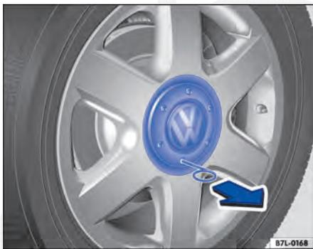
Fig. 202 Retirar a calota central.
