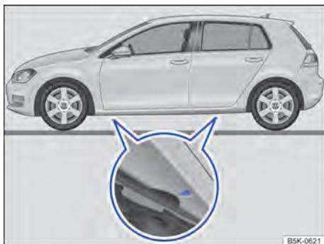
Fig. 208 Pontos de apoio do macaco.
