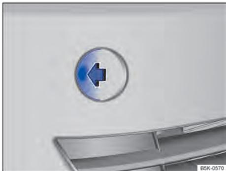
**Fig. 228** No para-choque dianteiro à direita: retirar a cobertura.
