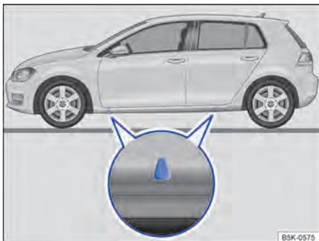
Fig. 206 Pontos de apoio do macaco.
