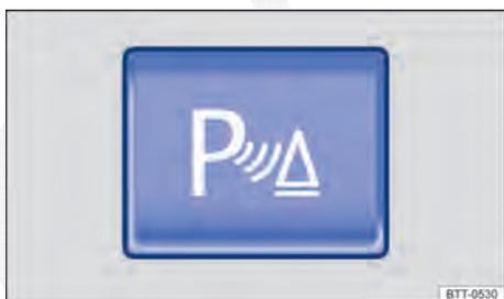
**Fig. 134** Na parte inferior do console central: botão para ligar e desligar o Park Pilot.
