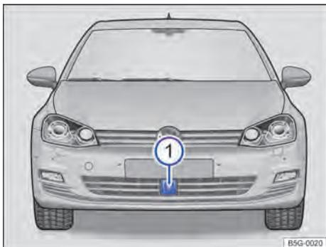
**Fig. 154** No para-choque dianteiro: sensor do radar.
