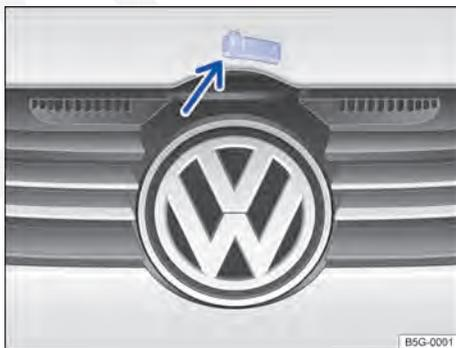
**Fig. 172** Alavanca de destravamento para abrir a tampa do compartimento do motor na grade do radiador.
