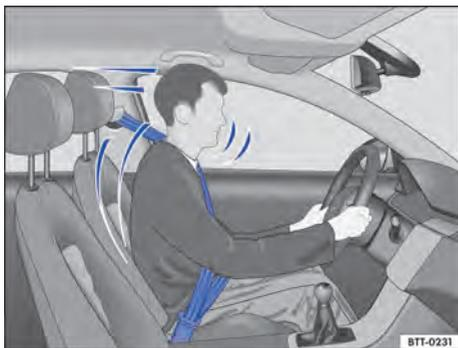
**Fig. 60** Conductor protegido pelo cinto de segurança colocado corretamente numa manobra de frenagem súbita.
