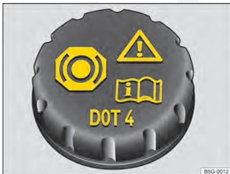
**Fig. 130** No compartimento do motor: tampa do reservatório do fluido de freio.
