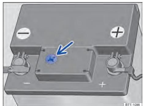
**Fig. 179** Representação esquemática: visor no lado superior da bateria 12 V do veículo.
