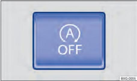
**Fig. 132** Na parte inferior do console central: botão do sistema Start-Stop.
