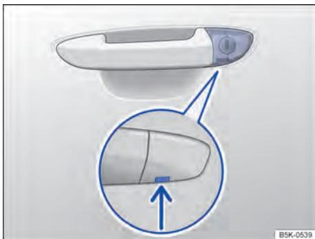
**Fig. 193** Maçaneta na porta do condutor: cilindro da fechadura coberto.
