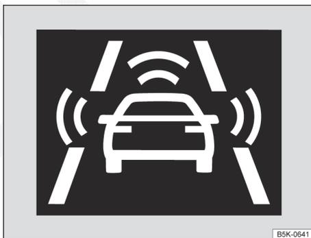
**Fig. 160** No display do instrumento combinado: exibição do alerta antecipado.
