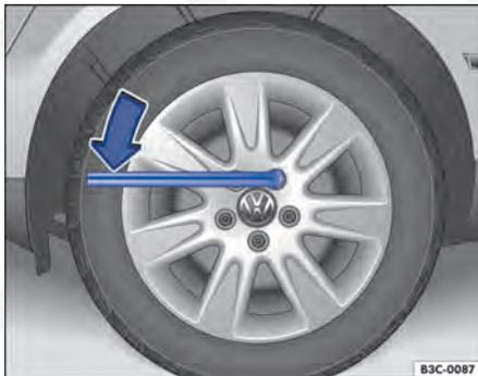
**Fig. 205** Troca de roda: soltar os parafusos de roda.
