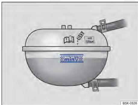
Fig. 176 No compartimento do motor: marcas no reservatório do líquido de arrefecimento do motor.
