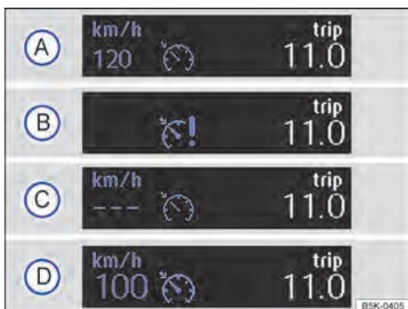
Fig. 146 No display do instrumento combinado: indicadores de status do GRA.
