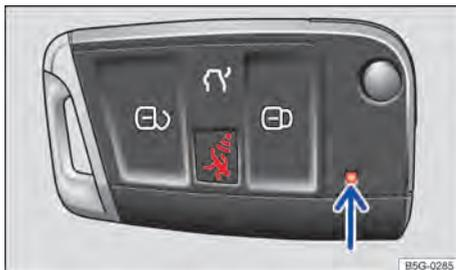
**Fig. 23** Luz de controle da chave do veículo com botão de alarme.
