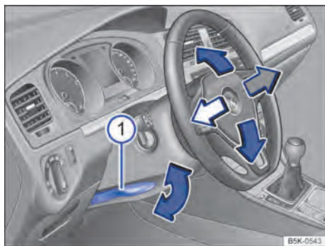
Fig. 82 Embaixo do volante no revestimento da coluna de direção: alavanca de ajuste mecânico da posição do volante.
