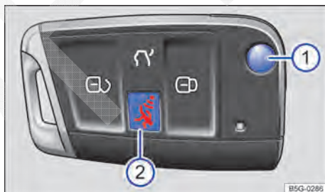
Fig. 57 Chave do veículo com botão do alarme.
