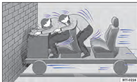
Fig. 5 Um veículo com os ocupantes do veículo sem cinto de segurança colide com o muro.
