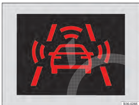
Fig. 143 No display do instrumento combinado: exibição do alerta antecipado.
