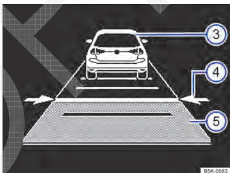
Fig. 137 No display do instrumento combinado: ACC ativo, veículo à frente reconhecido, distância temporal regulada.
