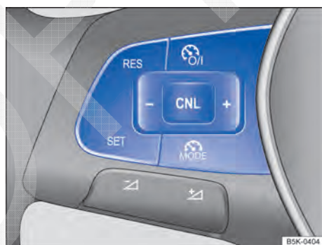
Fig. 132 Lado esquerdo do volante multifunções: botões para comandar o GRA.
