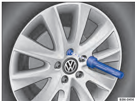
Fig. 251 Troca de roda: desaparafusar os parafusos de roda com o punho da chave de fenda.
