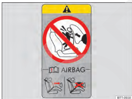
Fig. 24 Etiqueta do airbag na coluna B (representação esquemática).
