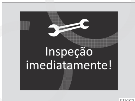
Fig. 48 No display do instrumento combinado: exemplo de indicação para um evento de serviço próximo de vencer (representação esquemática).
