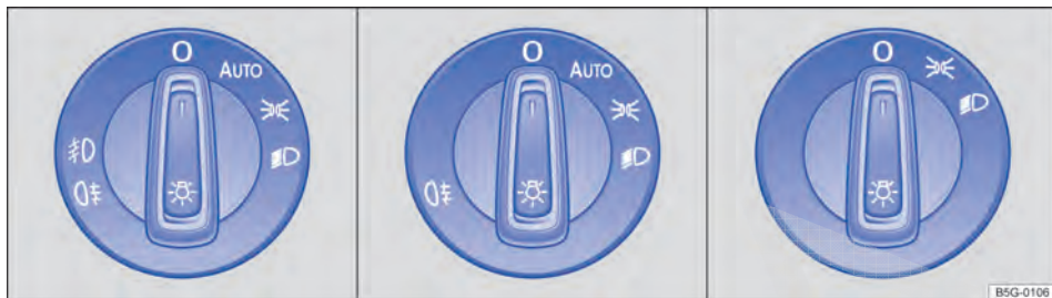
Fig. 95 Ao lado do volante: representação de algumas variantes do interruptor das luzes.
