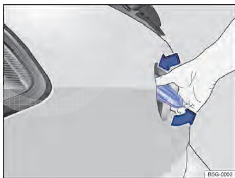
Fig. 70 Abrir a tampa do compartimento de bagagem por fora.
