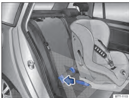
Fig. 27 Representação esquemática: instalar a cadeira de criança ISOFIX com os braços de apoio.
