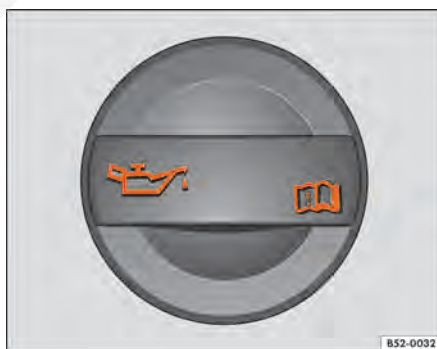
Fig. 228 No compartimento do motor: tampa da abertura para enchimento de óleo do motor.
