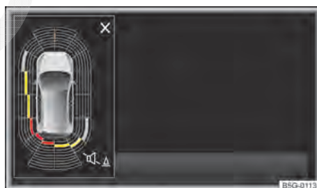
Fig. 148 Exibição do display da vista em miniatura nos arredores do veículo.
