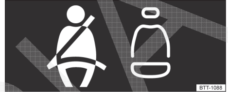
Fig. 3 Indicador de status do cinto de segurança no display do instrumento combinado para os assentos traseiros.
