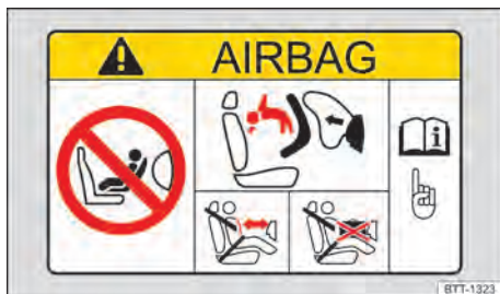
Fig. 23 Etiqueta do airbag no para-sol (representação esquemática).
