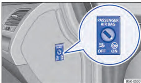
Fig. 17 No painel de instrumentos no lado do passageiro dianteiro: interruptor acionado pela chave para desligar e ligar o airbag frontal do passageiro dianteiro.
