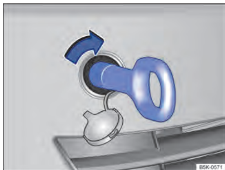
Fig. 220 No para-choque dianteiro à direita: rosquear a argola de reboque.
