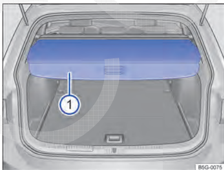
Fig. 175 No compartimento de bagagem: abrir e fechar a cobertura do compartimento de bagagem.
