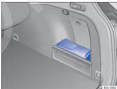
Fig. 252 No compartimento de bagagem à direita: porta-objetos com bolsa com ferramentas de bordo e, se for o caso, bolsa com macaco e chave de roda.
