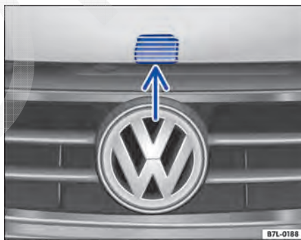
Fig. 222 Em cima da grade do radiador: alavanca de destravamento para abrir a tampa do compartimento do motor.
