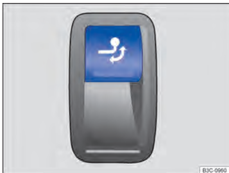
Fig. 133 No compartimento de bagagem à direita: botão para destravamento da rótula de engate.
