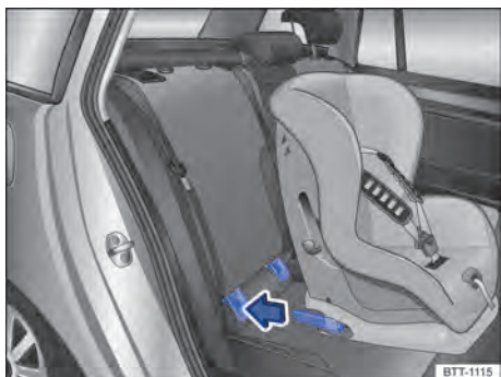
Fig. 88 Representação esquemática: instalar a cadeira de criança ISOFIX com os braços de apoio.
