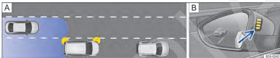
Fig. 204 Representação esquemática: A: situação de condução ao ultrapassar com o trânsito traseiro. B: indicador do assistente de mudança de faixa no espelho retrovisor externo esquerdo.
