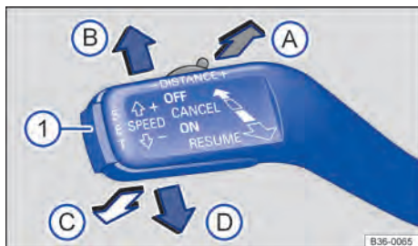
Fig. 194 Alavanca de operação ACC à esquerda na coluna de direção: regular a velocidade.
