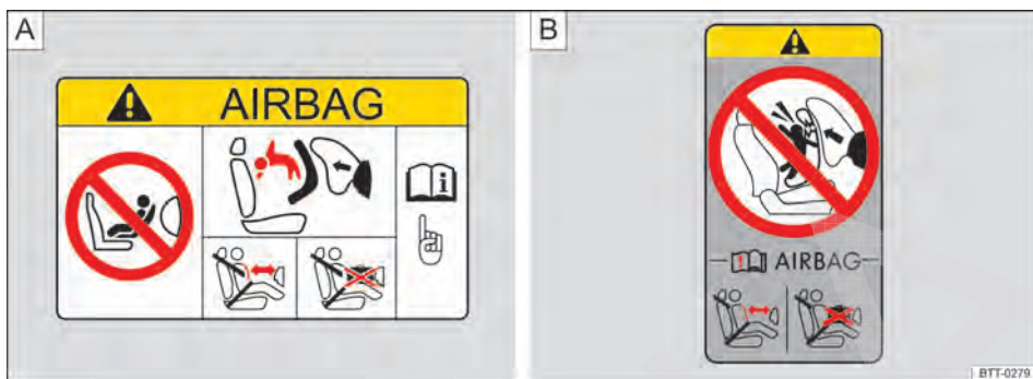
Fig. 85 Representação esquemática: etiqueta do airbag no para-sol (A) ou na coluna B (B).
