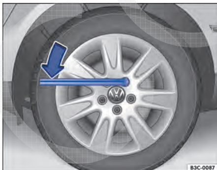
Fig. 258 Troca de roda: Afrouxar os parafusos de roda.
