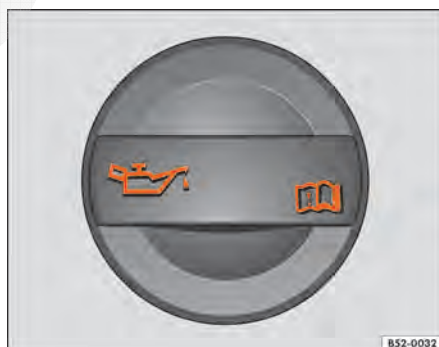
Fig. 224 No compartimento do motor: tampa da abertura para enchimento de óleo do motor.
