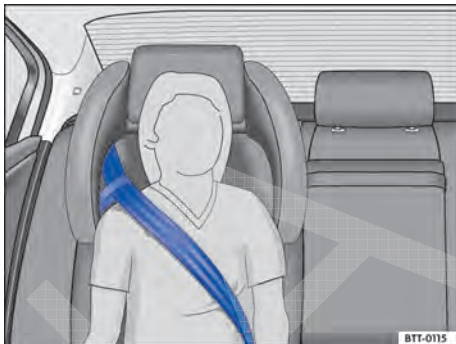
Fig. 93 Cadeira de criança integrada: posição do cadarço do cinto de segurança com alça de passagem do cinto de segurança.
