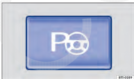
Fig. 186 Na parte inferior do console central: botão para ligar o assistente de direção para estacionamento.
