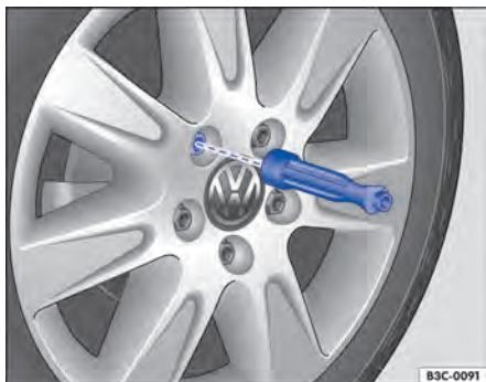
Fig. 266 Troca de roda: desparafusar os parafusos de roda com o punho da chave de fenda.
