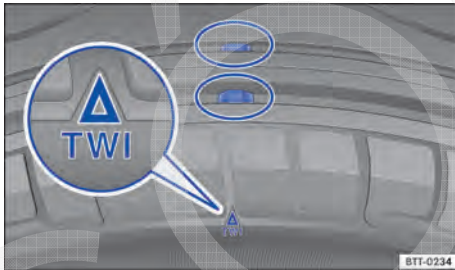
Fig. 236 Perfil do pneu: indicador de desgaste.
