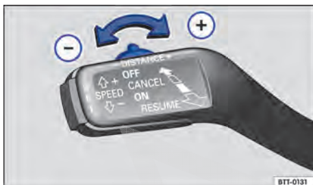
Fig. 195 Alavanca de operação ACC à esquerda na coluna de direção: ajustar o nível de distância.
