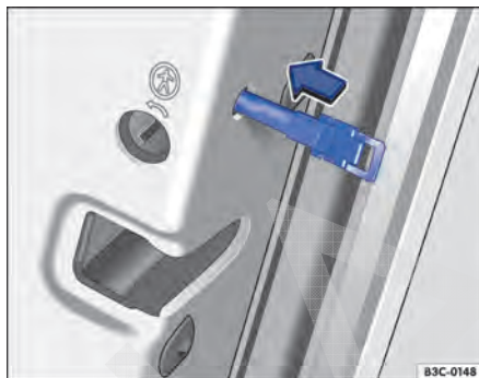
Fig. 245 Na parte dianteira da porta traseira direita: travamento de emergência do veículo com a chave de emergência.
