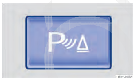
Fig. 178 Na parte inferior do console central: botão para ligar e desligar o Park Pilot.
