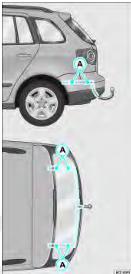
Fig. 131 Pontos de fixação do dispositivo de engate de reboque
