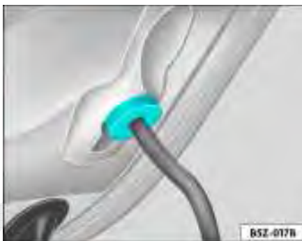
Fig. 137 Haste de sustentação da tampa do compartimento do motor
