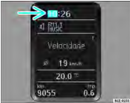
Fig. 39 Relógio no display do instrumento combinado: veículos com computador de bordo ou com sistema de informações Volkswagen
