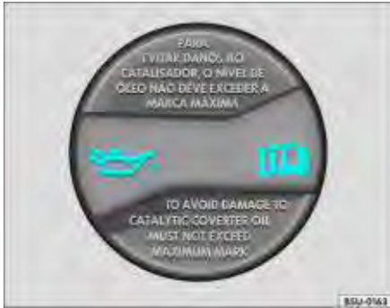
Fig. 139 No compartimento do motor: tampa do bocal de abastecimento de óleo
