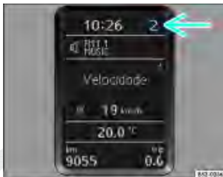
Fig. 123 Posições da alavanca seletora no display central: modo de condução manual, com a 2ª marcha engatada
