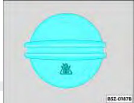
Fig. 141 No compartimento do motor: remover a tampa do reservatório do líquido de arrefecimento
