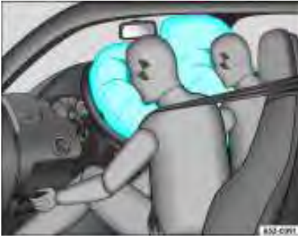
Fig. 24 Ilustração do funcionamento: airbags insuflados
