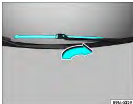
Fig. 143 Levantamento do braço do limpador do para-brisa
