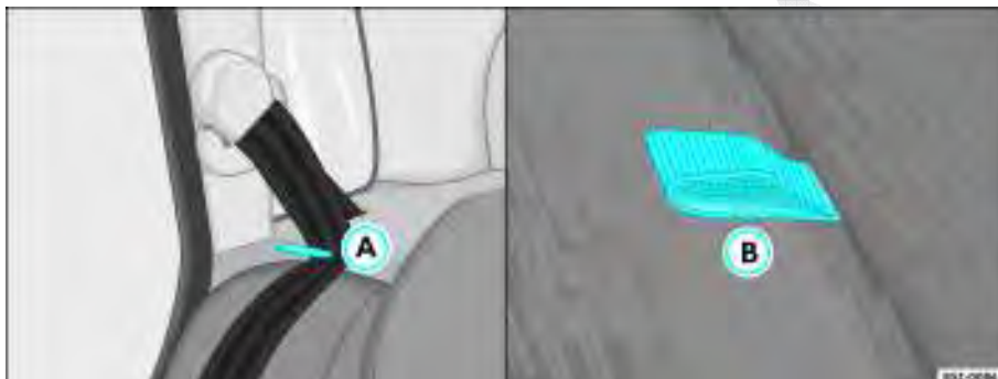
Fig. 96 Posicionador do cinto para rebatimento do banco / uma das alças para desbloqueio do encosto
