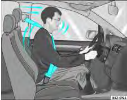
Fig. 11 Condutor protegido pelo cinto de segurança corretamente colocado durante uma freada brusca
