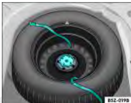
Fig. 158 Manípulo de fixação da roda de emergência
