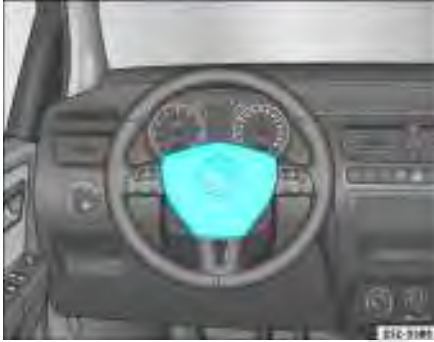
Fig. 21 Localização do airbag do condutor: no volante
