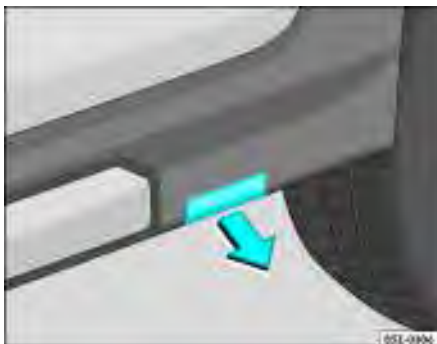
Fig. 165 Pontos de recepção do macaco
