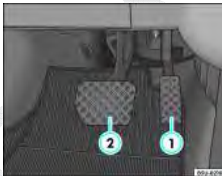
Fig. 5 Pedais nos veículos com transmissão automatizada ASG: ① pedal do acelerador e ② pedal do freio
