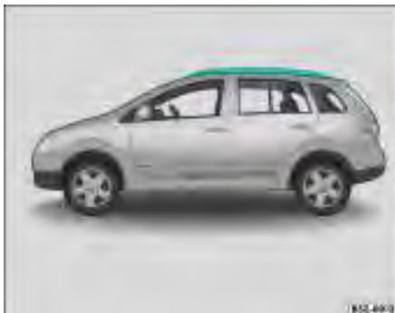
Fig. 108 Suportes longitudinais do bagageiro no teto
