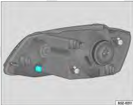
Fig. 175 Localização da lâmpada da lanterna dianteira (luz de posição)
