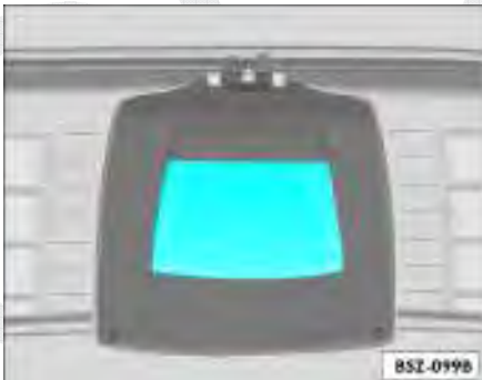
Fig. 64 Detalhe do revestimento interno da tampa do compartimento de bagagem: rebaixo para fechar
