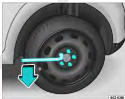
Fig. 163 Desaperto dos parafusos da roda
