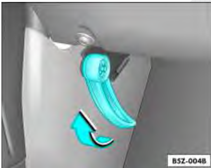
Fig. 135 Detalhe da região dos pés no lado do condutor: alavanca desbloqueadora da tampa do compartimento do motor
