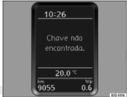
Fig. 117 Texto de advertência no display: veículos com computador de bordo ou com sistema de informações Volkswagen
