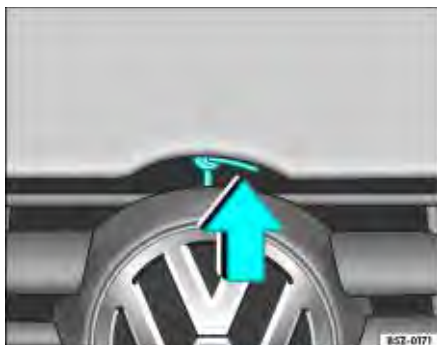
Fig. 136 Detalhe da grade do radiador: trava de segurança para abrir a tampa do compartimento do motor
