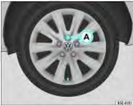
Fig. 167 Sequência de remoção dos parafusos da roda
