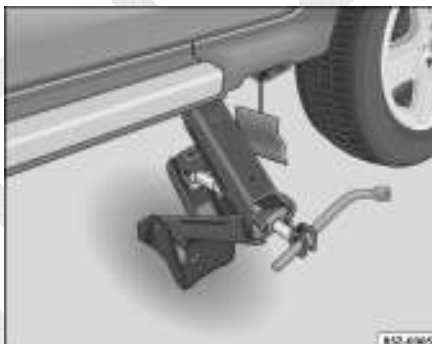
Fig. 166 Macaco colocado na parte traseira, lado esquerdo
