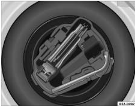
Fig. 155 Posicionamento correto da caixa de ferramentas e da roda de emergência - SpaceFox
