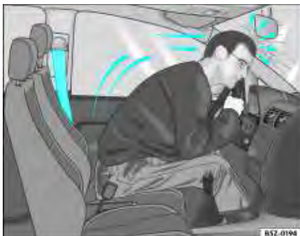
Fig. 9 O condutor que não colocou o cinto de segurança é projetado violentamente para a frente
