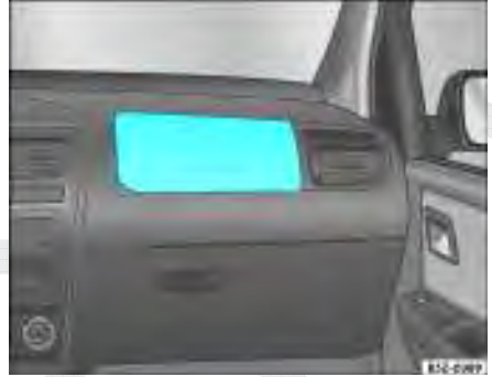
Fig. 22 Localização do airbag do passageiro do banco dianteiro: no painel de instrumentos
