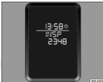
Fig. 42 Indicador do próximo serviço. A figura mostra, como exemplo, o display de um veículo sem sistema de informações Volkswagen ou sem computador de bordo.
