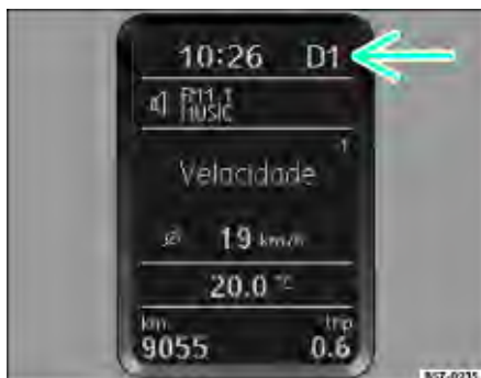
Fig. 124 Posições da alavanca seletora no display central: indicação da alavanca no modo de condução normal
