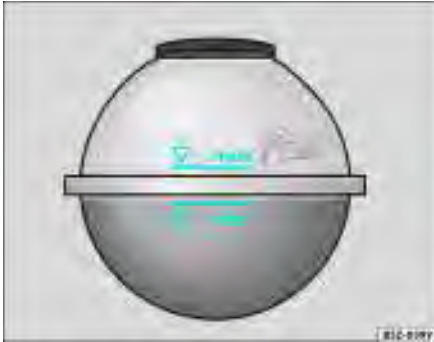
Fig. 140 Reservatório de expansão do líquido de arrefecimento
