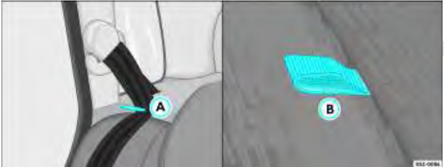
Fig. 89 Posicionador do cinto para rebatimento do banco / alça para desbloqueio do encosto
