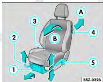
Fig. 85 Elementos para a regulagem do banco dianteiro lado condutor
