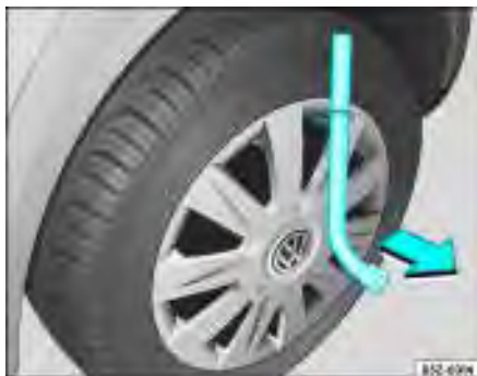
Fig. 159 Remover a supercalota
