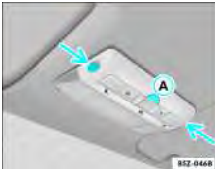
Fig. 60 Botão para desativar o monitoramento do compartimento interno
