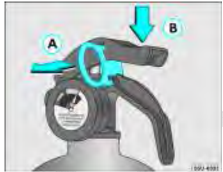
Fig. 33 Sequência de utilização do extintor de incêndio
