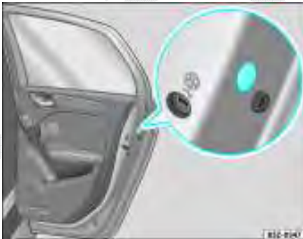
Fig. 168 Trava de emergência coberta pela tampa de borracha
