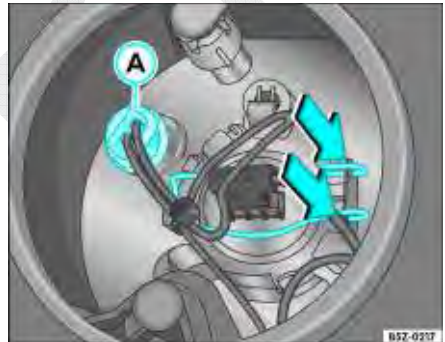
Fig. 182 Acesso à lâmpada do farol alto / lanterna dianteira (luz de posição)
