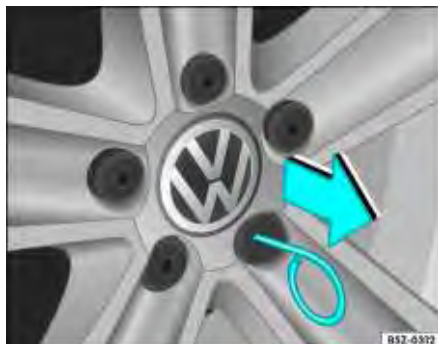
Fig. 162 Retirar os protetores dos parafusos
