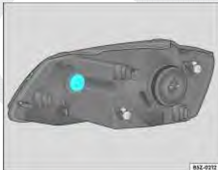
Fig. 177 Localização da lâmpada do indicador de direção dianteiro
