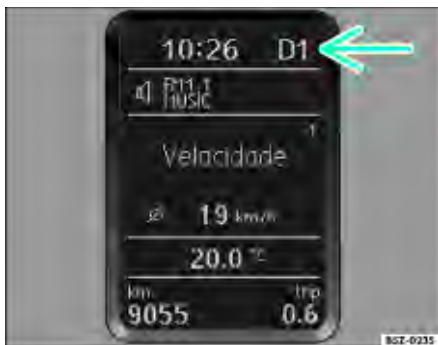
Fig. 122 Posições da alavanca seletora no display central: indicação da alavanca no modo de condução normal (Drive), com a 1ª marcha engatada
