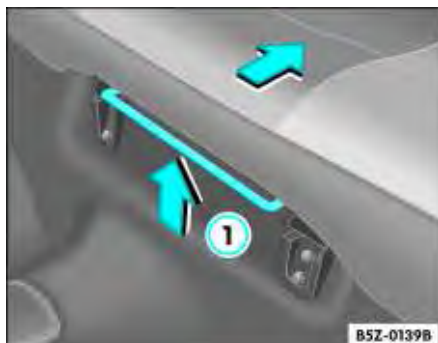
Fig. 93 Alavanca para regulação longitudinal
