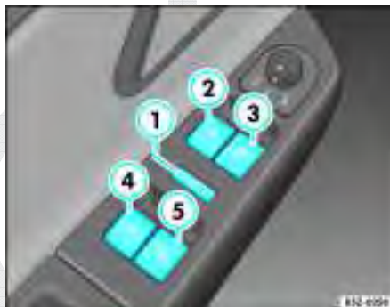
Fig. 65 Detalhe do descanso-braço da porta do condutor: teclas de comando dos vidros e interruptor de segurança dos vidros traseiros
