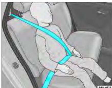
Fig. 30 Cinto de segurança do veículo colocado corretamente para crianças com idade superior a 7 anos e meio e inferior ou igual a 10 anos
