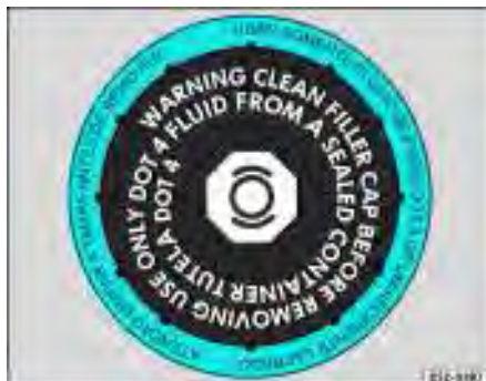
Fig. 146 Etiqueta circular encaixada logo abaixo da tampa do reservatório de fluido dos freios
