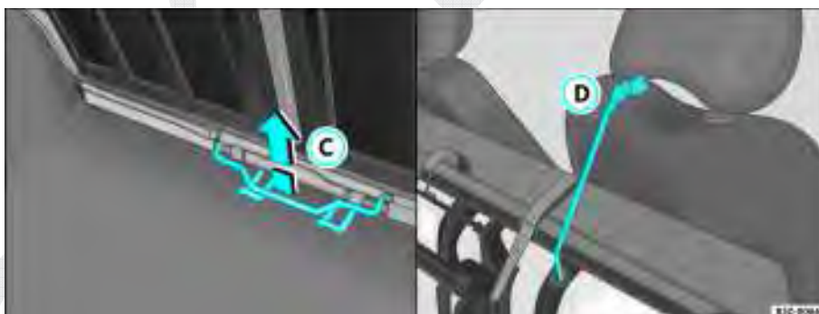
Fig. 97 Alavanca para destravar o conjunto do assoalho / banco rebatido fixado com a cinta elástica vermelha na haste do apoio para cabeça
