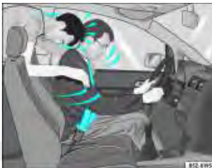
Fig. 10 O passageiro do banco traseiro que não colocou o cinto de segurança é projetado para a frente, para cima dos passageiros dos bancos dianteiros
