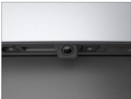
Fig. 175 Na traseira do veículo: câmera de marcha a ré no botão da alça (representação esquemática).
