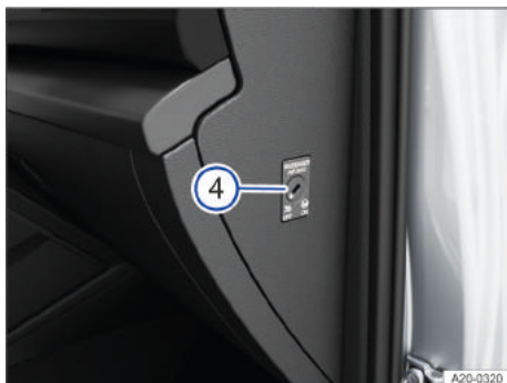
Fig. 9 Com a porta do passageiro dianteira aberta: interruptor acionado pela chave no painel de instrumentos.
