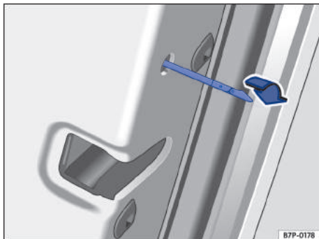
Fig. 46 Na parte dianteira da porta traseira direita: travamento de emergência do veículo com a chave de emergência (variante 1).
