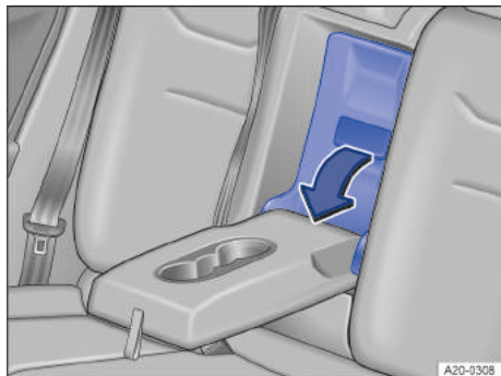
Fig. 122 No encosto do banco traseiro: abrir o dispositivo para transporte de objetos longos.
