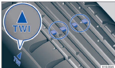
Fig. 160 Perfil do pneu: indicador de desgaste.
