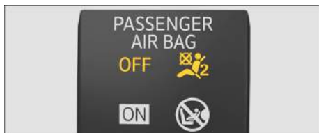
Fig. 26 No console central: luz de controle (representação esquemática) do airbag frontal do passageiro dianteiro desativado.
