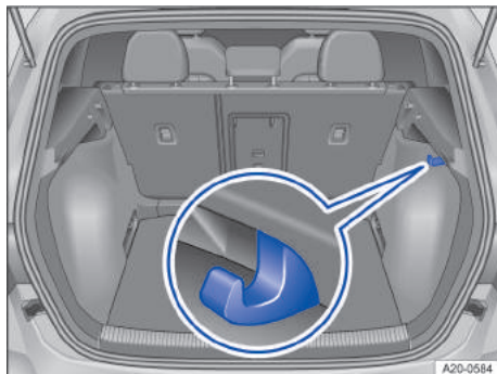
Fig. 121 No compartimento de bagagem à esquerda e à direita: ganchos para sacolas.
