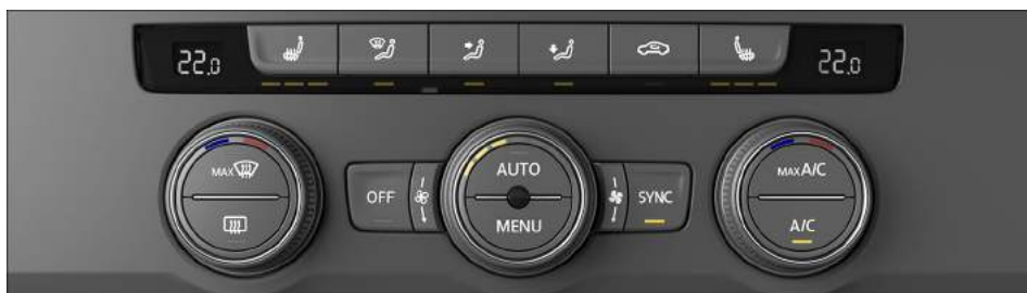
Fig. 81 Na parte superior do console central: painel de comando do ar-condicionado do Climatronic.
