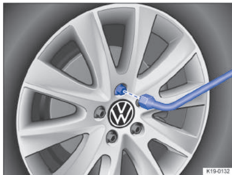
Fig. 173 Troca de roda: desaparafusar os parafusos de roda com a chave de roda.
