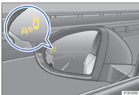
Fig. 107 Nos espelhos retrovisores externos: indicação do sensor de ponto cego.
