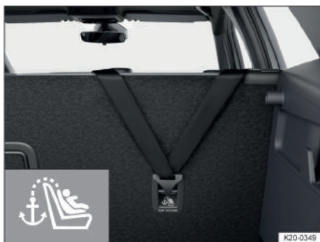
Fig. 38 No compartimento de bagagem: cinto de fixação superior pendurado.
