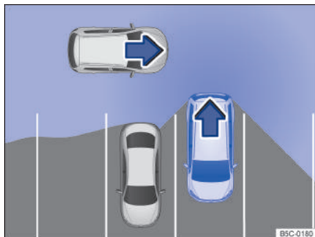
Fig. 111 Representação esquemática do assistente de saída de vaga: área monitorada ao redor do veículo.
