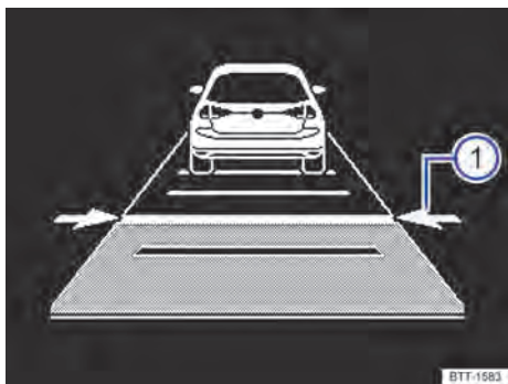
Fig. 143 No display do instrumento combinado: distância configurada ① (representação esquemática, ACC regulando).
