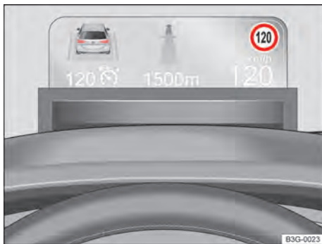
Fig. 16 No painel de instrumentos acima do volante: exemplos de indicações no head-up display.
