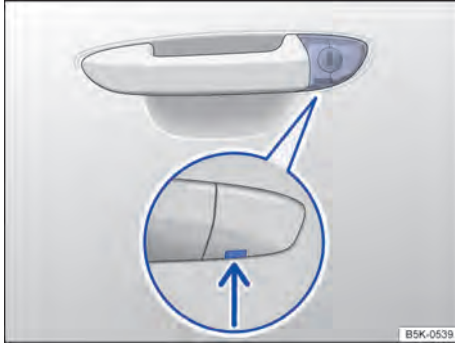
Fig. 66 Maçaneta da porta do condutor: cilindro da fechadura coberto.
