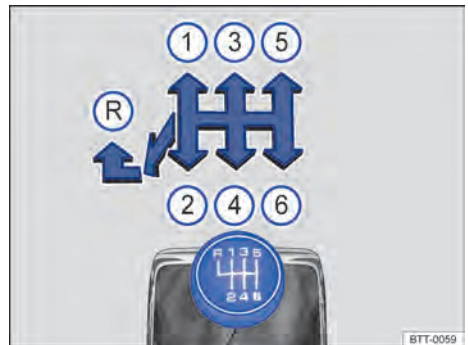
Fig. 122 Esquema de troca da transmissão manual de 6 marchas.
