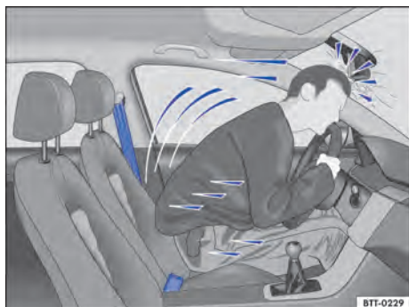
Fig. 33 O condutor sem cinto de segurança é lançado para frente.
