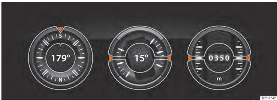
Fig. 130 Indicação no sistema Infotainment: indicação off-road.
