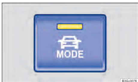
Fig. 128 Na parte inferior do console central: botão de seleção do perfil de condução.
