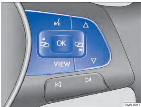
Fig. 24 Lado direito do volante multifunções: botões para comando dos menus e exibições de informação do instrumento combinado.
