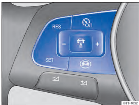
Fig. 142 Lado esquerdo do volante multifunções: botões para comandar o ACC.
