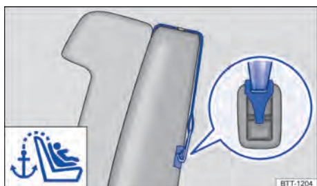
Fig. 56 Na parte traseira da segunda fileira de assentos: olhal de retenção do cinto de fixação superior.
