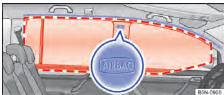
Fig. 47 No lado esquerdo do veículo (veículos com 5 assentos): local de instalação e área de expansão do airbag para cabeça.
