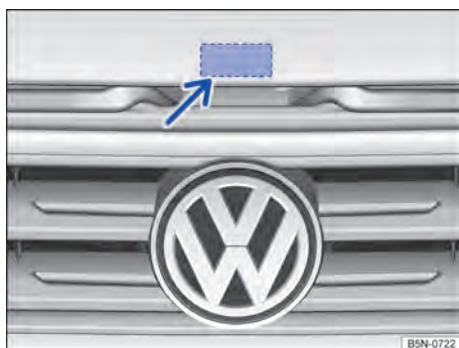
Fig. 217 Pela grade do radiador: alavanca de abertura da tampa do compartimento do motor.
