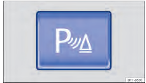
Fig. 147 No console central: botão para ligar e desligar o auxílio de estacionamento (dependendo da versão).
