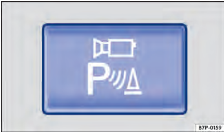
Fig. 154 No console central: botão para ligar a visão do ambiente manualmente.
