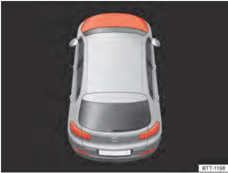
Fig. 218 No display do instrumento combinado: tampa do compartimento do motor aberta ou fechada incorretamente (representação esquemática).
