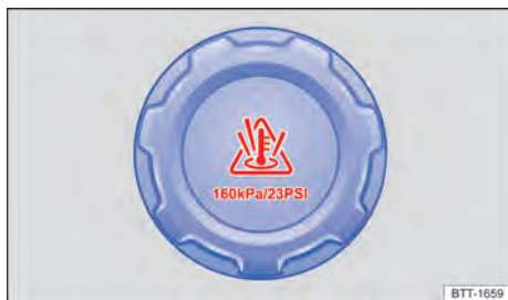
Fig. 223 No compartimento do motor: tampa do reservatório de expansão do líquido de arrefecimento do motor (representação esquemática).
