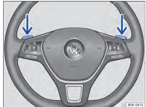
Fig. 125 Volante com seletores basculantes do Tiptronic.
