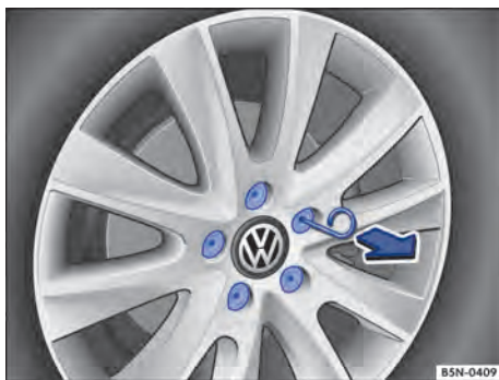
Fig. 236 Remover as capas de cobertura dos parafusos de roda.
