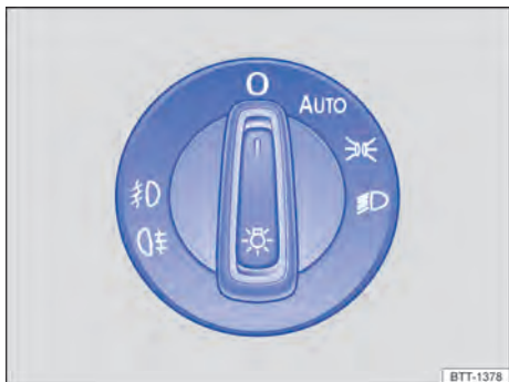
Fig. 98 Ao lado do volante: interruptor de luzes (uma variante).
