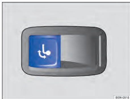
Fig. 187 À esquerda do compartimento de bagagem: botão para destravamento da rótula de engate.
