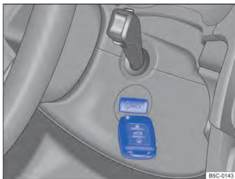
Fig. 120 À direita na coluna de direção: função de partida de emergência em veículos com sistema de travamento e de partida Keyless Access sem chave.
