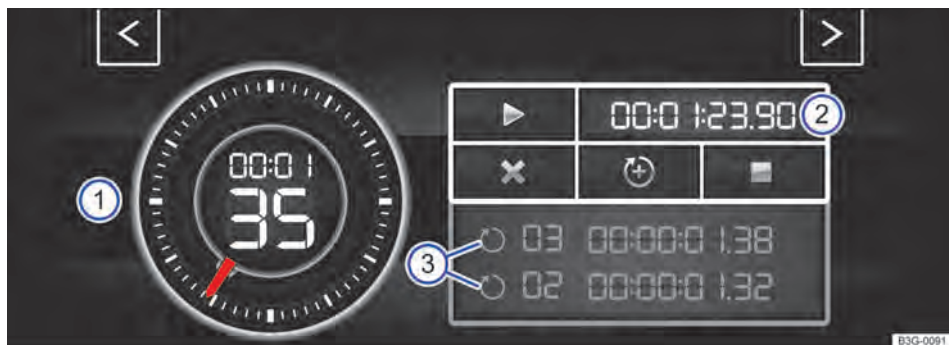
Fig. 26 No display do sistema Infotainment: Laptimer com cronômetro, superfície de função e tempos de voltas.
