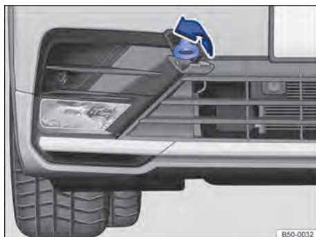
Fig. 215 No para-choque dianteiro à direita: rosquear a argola de reboque.
