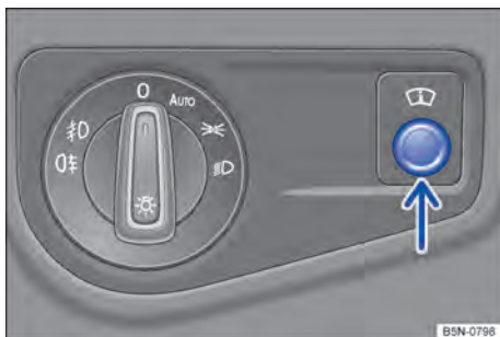
Fig. 15 Ao lado do volante: regulador do head-up display (seta).
