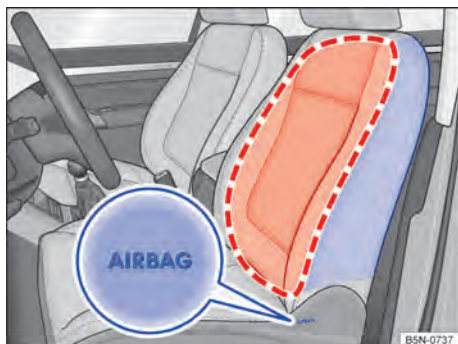
Fig. 46 Lateralmente no banco dianteiro: local de instalação e área de expansão dos airbags laterais.
