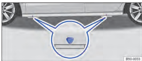
Fig. 239 Pontos de apoio do macaco.
