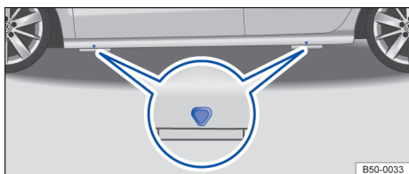
Fig. 243 Pontos de apoio do macaco.
