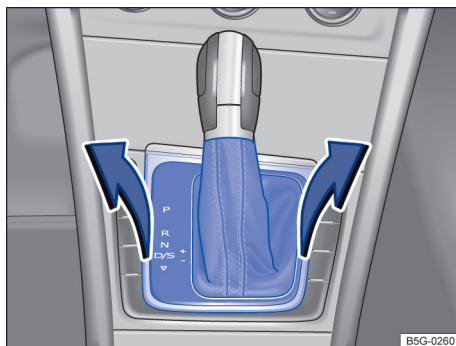
Fig. 128 Desinstalar a cobertura do quadro da alavanca seletora.
