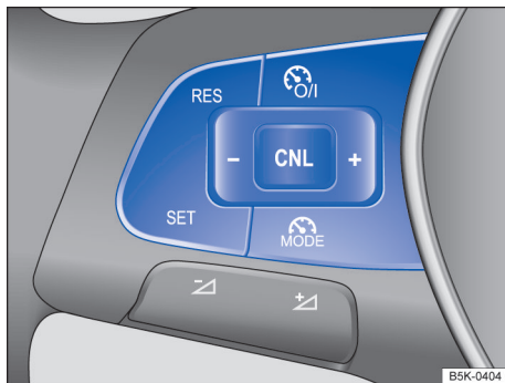
Fig. 143 Lado esquerdo do volante multifunções: botões para comandar o limitador de velocidade.
