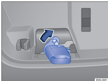
Fig. 75 No compartimento de bagagem: destravamento de emergência da tampa do compartimento de bagagem.
