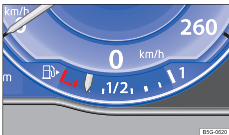
Fig. 19 No instrumento combinado digital, indicador do nível de combustível.
