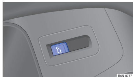
Fig. 70 Na porta do condutor: botão de destravamento da tampa do compartimento de bagagem.
