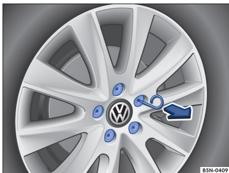
Fig. 240 Remover as capas de cobertura dos parafusos de roda.
