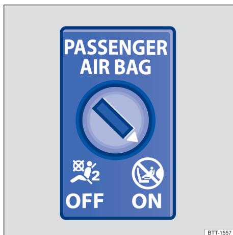
Fig. 46 No painel de instrumentos no lado do passageiro dianteiro ou no porta-objetos: interruptor acionado pela chave para desligar e ligar o airbag frontal do passageiro dianteiro.
