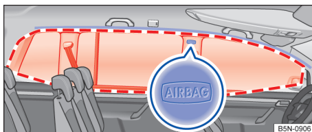
Fig. 50 No lado esquerdo do veículo (veículos com 7 assentos): local de instalação e área de expansão do airbag para cabeça.
