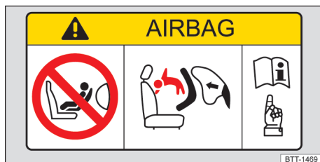
Fig. 54 Representação esquemática: etiqueta de airbag na para-sol.
