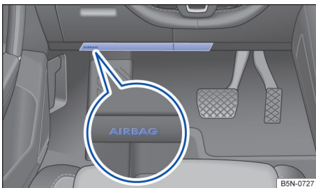
Fig. 51 No lado do condutor: local de instalação do airbag para joelhos.
