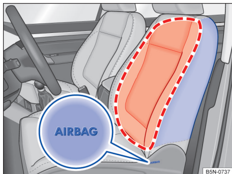
Fig. 48 Lateralmente no banco dianteiro: local de instalação e área de expansão dos airbags laterais.
