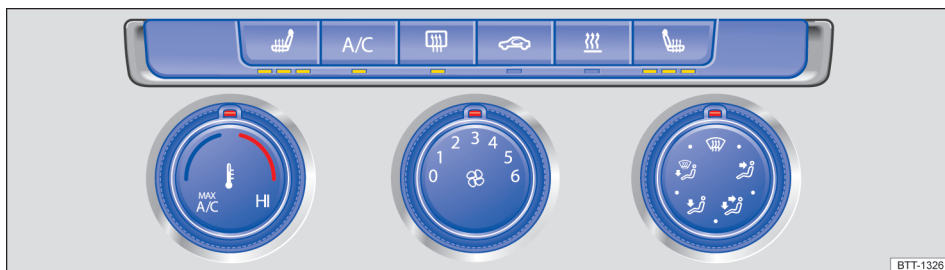
Fig. 112 Na parte superior do console central: comandos do ar-condicionado manual ou do sistema de aquecimento e ventilação de ar fresco.
