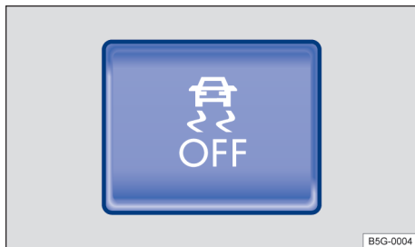
Fig. 160 No controle central: botão para desligar e ligar o ASR manualmente.
