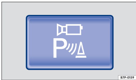
Fig. 158 No console central: botão para ligar a visão do ambiente manualmente.
