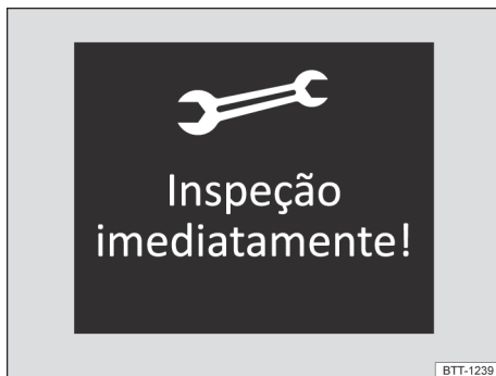
Fig. 22 No display do instrumento combinado: exemplo de indicação para um evento de serviço próximo de vencer (representação esquemática).
