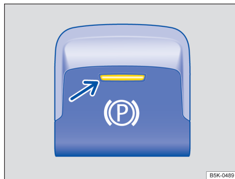
Fig. 149 No console central: botão do freio de estacionamento eletrônico.
