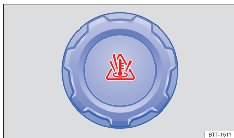
Fig. 227 No compartimento do motor: tampa do reservatório de expansão do líquido de arrefecimento do motor (representação esquemática).
