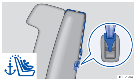
Fig. 58 Na parte traseira da segunda e terceira fileira de assentos: olhal de retenção do cinto de fixação superior.
