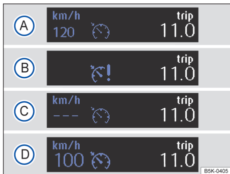
Fig. 138 No display do instrumento combinado: indicadores de status do GRA (representação esquemática).
