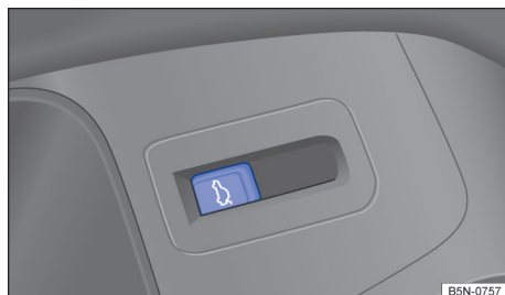
Fig. 64 Na porta do condutor: destravamento da tampa do compartimento de bagagem.
