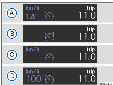
Fig. 140 No display do instrumento combinado: indicadores de status do GRA (representação esquemática).
