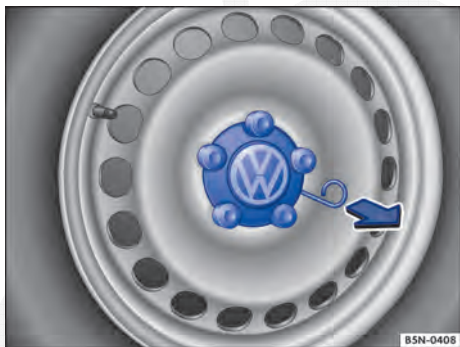
Fig. 229 Retirar a calota central.
