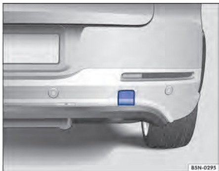
Fig. 257 Para-choque traseiro direito: cobertura do alojamento da argola de reboque.
