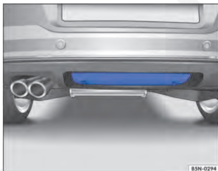
Fig. 111 Para-choque traseiro: cobertura do dispositivo de reboque (R-Line).
