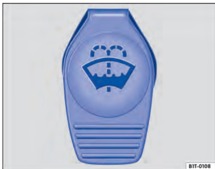
Fig. 93 No compartimento do motor: tampa do reservatório de água dos lavadores dos vidros.
