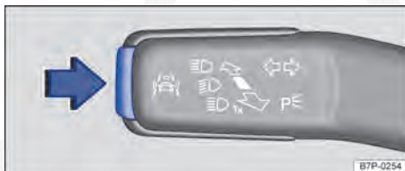
Fig. 17 Na alavanca dos indicadores de direção e do farol alto: botão dos sistemas de assistência ao condutor.
