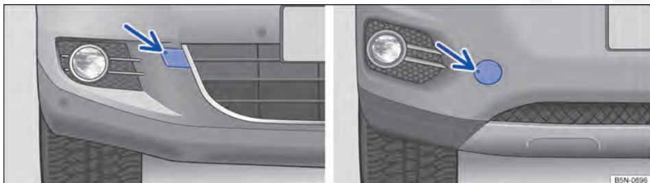
Fig. 253 No para-choque dianteiro à direita: capa de cobertura para o alojamento da argola de reboque.
