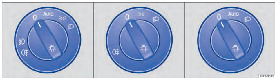
Fig. 84 Ao lado do volante: representação de algumas variantes do interruptor das luzes.
