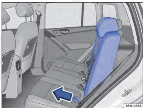
Fig. 58 Rebater o encosto do banco traseiro para frente e de volta.
