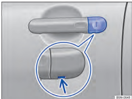
Fig. 219 Maçaneta da porta do condutor: cilindro da fechadura coberto.
