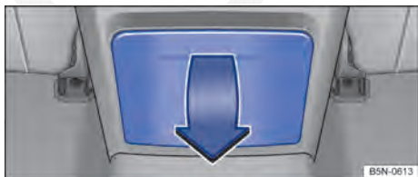
Fig. 135 No console central traseiro: abrir a cobertura das tomadas.
