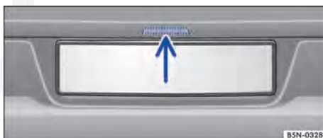
Fig. 35 Na tampa do compartimento de bagagem: botão para abrir a tampa do compartimento de bagagem.
