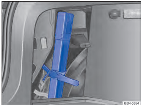
Fig. 217 No porta-objetos esquerdo do compartimento de bagagem: suporte para o triângulo de segurança.
