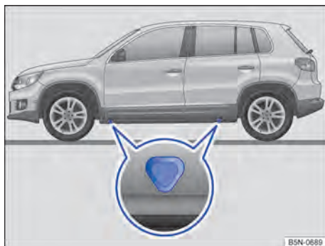
Fig. 234 Pontos de apoio do macaco.
