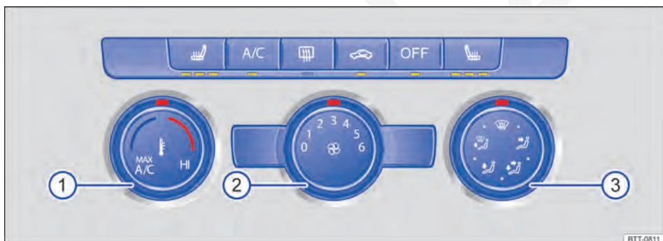
Fig. 177 No console central: elementos de operação do ar-condicionado (manual).
