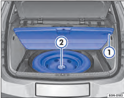
Fig. 208 No compartimento de bagagem: roda de emergência.
