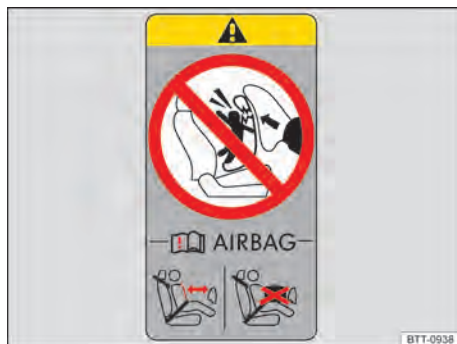
Fig. 78 Representação esquemática: etiqueta de airbag na coluna B.
