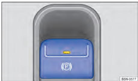
Fig. 149 Na parte inferior do console central: botão do freio de estacionamento eletrônico.
