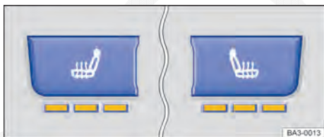
Fig. 181 Na parte superior do console central: botões do aquecimento dos bancos dianteiros.
