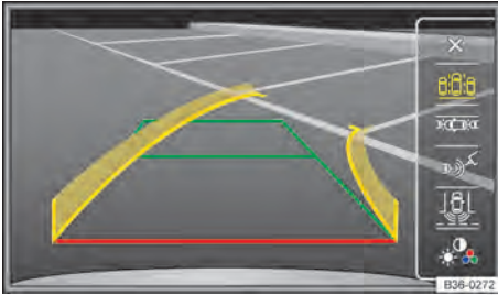
Fig. 161 Exibição do display da câmera de marcha a ré: modo 1 ligado.
