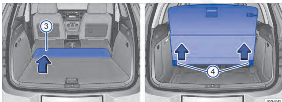
Fig. 105 No compartimento de bagagem: ampliar o compartimento de bagagem para frente ou para baixo.
